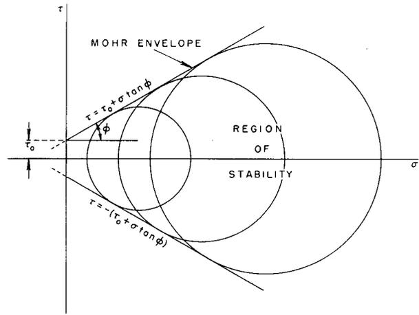
FIG. 10—TYPICAL MOHR ENVELOPES FOR ROCK.
